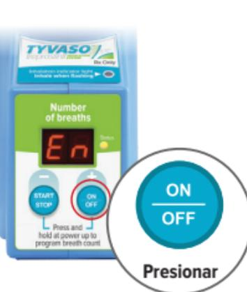
Para apagar el aparato, presione y sostenga el botón ON/OFF por 3 segundos y luego suéltelo.
